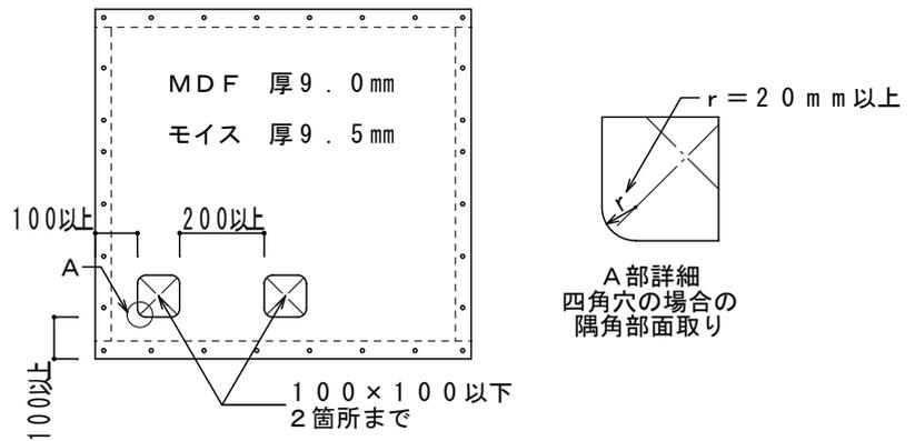
耐震ボードの切断には、手挽き鋸を用いるか、大量に切断する場合は、超合金の刃先のついた電動鋸を用いてください。面取りは、面取りかんな又はサンドペーパーを用いるか、大量に加工する場合は、電動プレーナー又は電動サンダーを用いてください。穴あけには、キリ又はドリルを用いてください。
