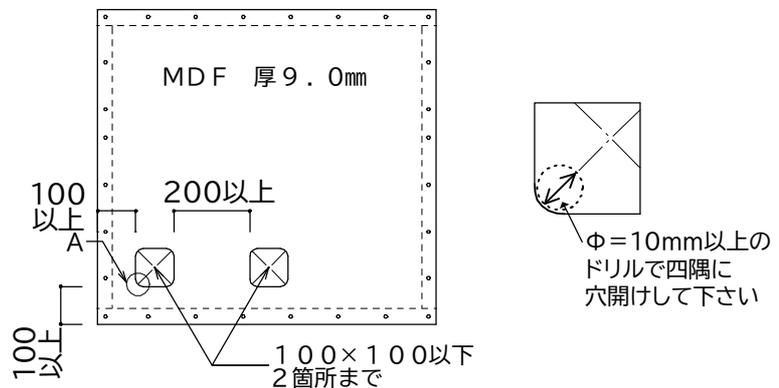
耐震ボードの切断には、手挽き鋸を用いるか、大量に切断する場合は、超合金の刃先のついた電動鋸を用いてください。面取りは、面取りかな又はサンドペーパーを用いるか、大量に加工する場合は、電動プレーナー又は電動サンダーを用いてください。穴あけには、キリ又はドリルを用いてください。
