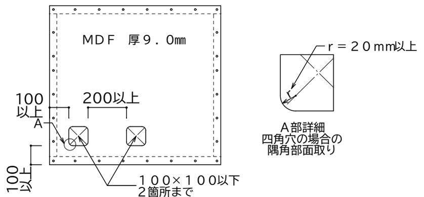
耐震ボードの切断には、手挽き鋸を用いるか、大量に切断する場合は、超合金の刃先のついた電動鋸を用いてください。面取りは、面取りかな又はサンドペーパーを用いるか、大量に加工する場合は、電動ブレーナー又は電動サンダーを用いてください。穴あけには、キリ又はドリルを用いてください。
