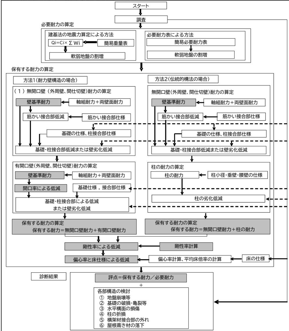
精密診断法における「壁基準耐力」「壁基準剛性」
