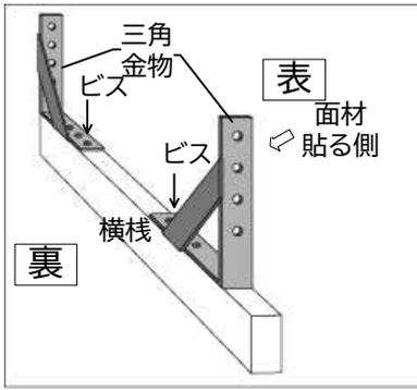
・横棧4本に、予め耐震補強用専用ビスで横棧受け金物を2個ずつ設置しておきます
