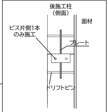
後施工柱(中間柱)は両側耐力壁でご利用ください(端部柱には不可)
