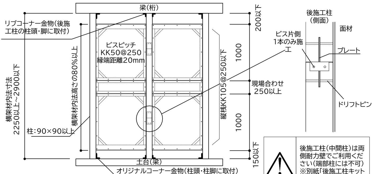
後施工柱(中間柱)は両側耐力壁でご利用ください(端部柱には不可)
