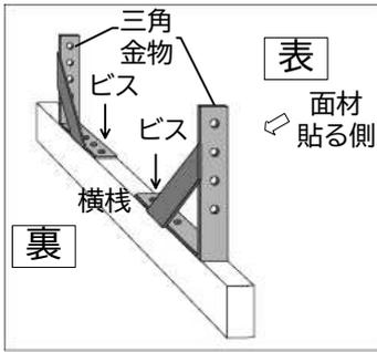
・横棧4本に、予め耐震補強専用ビスで横棧受け金物を2個ずつ設置しておきます
