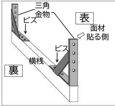
横棧4本に、予め耐震補強用専用ビスで横棧受け金物を2個ずつ設置しておきます
