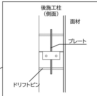
後施工柱(中間柱)は両側耐力壁でご利用ください(端部柱には不可)
