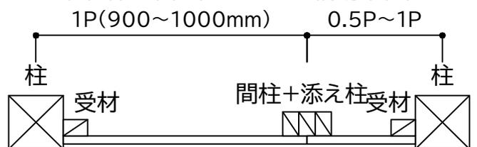
⑨MDF 真壁 後施工柱 I
