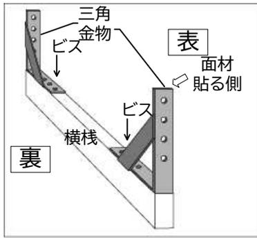
・横棧2本に、予め耐震補強用専用ビスで横棧受け金物を2個ずつ設置しておきます
