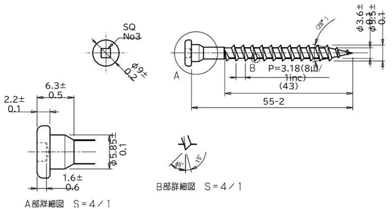
■後施工柱キット 柱継目補強金物
