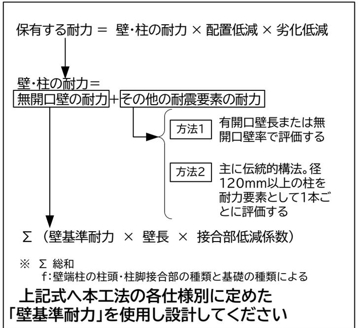
図2.精密診断法1(保有耐力診断)の流れ
