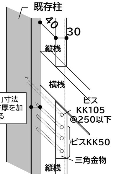
仕上りの「ちり」寸法に、耐震ボード厚を加えた寸法とする
