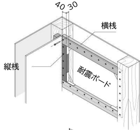
仕上りの「ちり」寸法に、耐震ボード厚を加えた寸法とする
