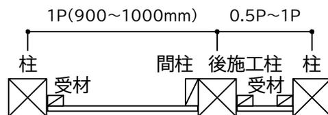
参考)後施工柱の納まり例
