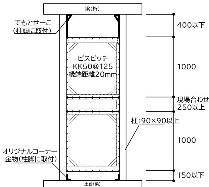
注意:MDFかべつよしの1.5～2P仕様【3】大壁添え柱・【4】大壁後施工柱・【7】真壁後施工柱では、別途「てもとせーこ 柱2箇所セット」が必要です
