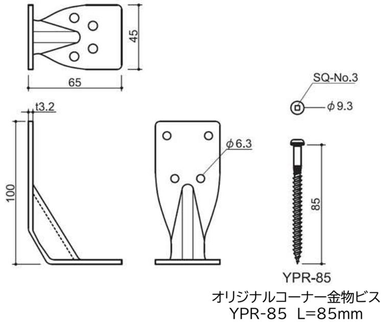
柱頭・柱脚金物の仕様別接合耐力 (下記の通り、中間柱、隅柱の別で金物の耐力が異なります。)
