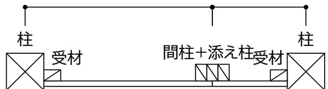
ビスは、添え柱の中心へ留め付け、添え柱と間柱の継ぎ目をさけてください
